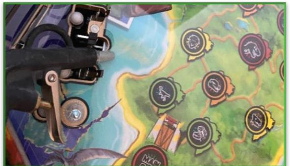
Am besten mit Druckluft unter den Protektor blasen.
