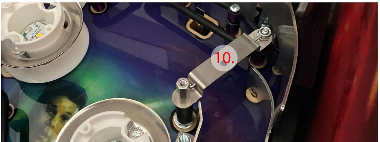
11. 2x Gates lösen (kann man einseitig lösen und dann zur Seite schieben)
