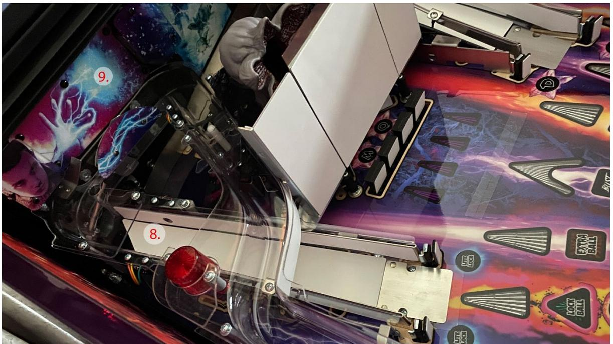
Nun muss die mittlere Rampe/Leinwand ausgebaut werden. Links und rechts sind je zwei Schrauben zu lösen. Eine kleine Kreuzschraube beim Plastik und eine Mutter beim Gate. Dazu kommt noch eine Kreuzschraube von der klappbaren Rampe. Bitte nicht vergessen, die Stecker von den Kabeln unter dem Spielfeld zu lösen.
