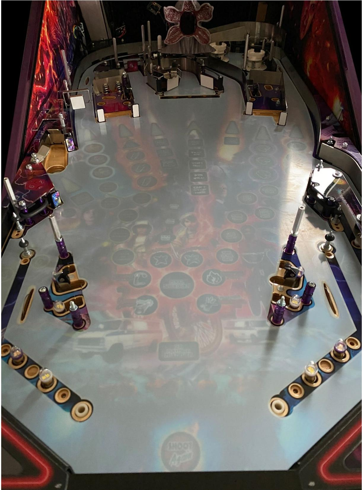
Die Drop Target Bank in der Mitte muss dann noch in der Höhe angepasst werden. Dies kann man durch Justieren von zwei Kreuzschrauben unter dem Spielfeld an der Target Bank einstellen.
